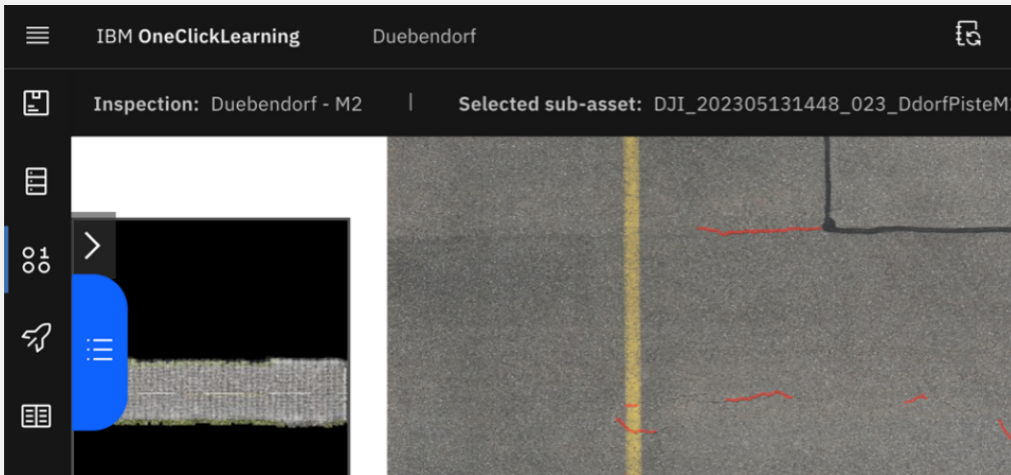
Abbildung 9: OCL-Bildbetrachtung, auf der Rissdetektionen auf dem Originalbild in Rot markiert sind
