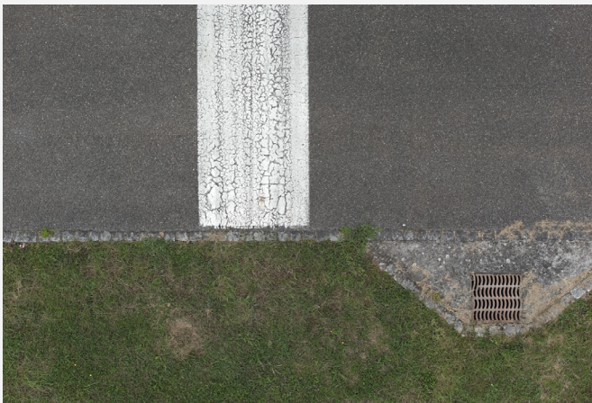
Abbildung 3: Repräsentatives Beispiel der ursprünglich erfassten Bilder von M2. Die Bilder haben eine Auflösung von 0,75 mm/Pixel. Im Vergleich zu M1 hat M2 eine 3-mal grössere GSD. Das wird deutlich an der ungefähr 9-mal grösseren Fläche, die das Referenzbild von M2 abdeckt.
